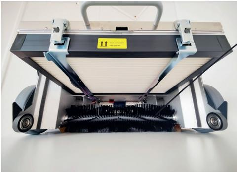
**(4)** Überprüfen Sie die Walzenbürste, um sicherzustellen, dass kein Material um die Bürste, das Lager oder den Antriebsmotor gewickelt ist.
