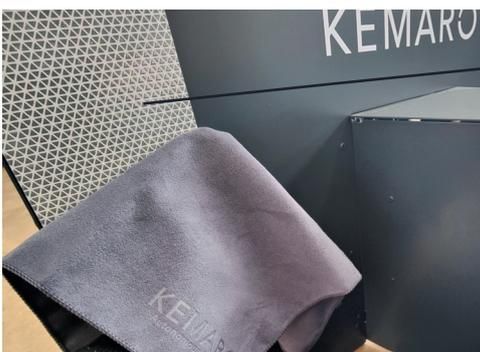
**(6)** Reinigen Sie die Reflexionsstreifen.
