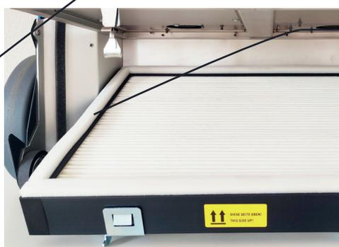
**(8)** Überprüfen Sie die Schaumstoffdichtung im Schmutzbehälter (oben innen aufgeklebt) und am Roboter auf Verschleiss.
