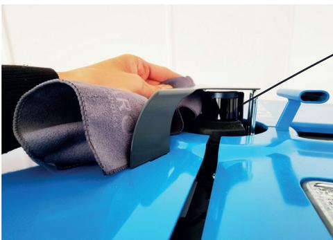
**(2)** Reinigen Sie den LiDAR mit Druckluft oder einem weichen fusselfreien Tuch oder Mikrofaser Tuch.
