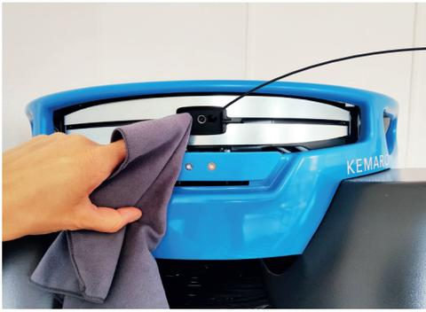
**(3)** Reinigen Sie beide Linsen des 3D-Sensors (mit einem Tuch oder einem Wattestäbchen).
