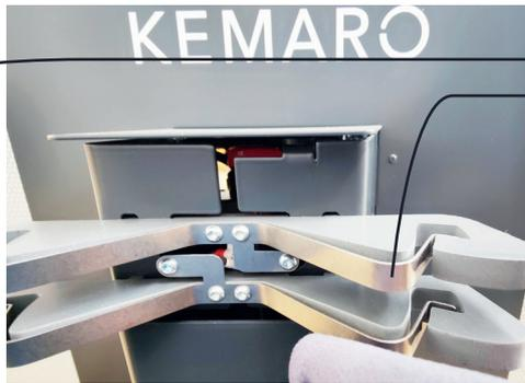
**(4)** Reinigen Sie die Ladkontakte am Roboter und an der Ladestation mit einem Tuch.
